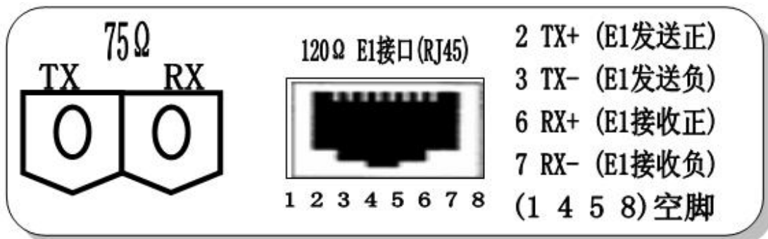
图4. 接口转换器 E1接口管脚定义图
