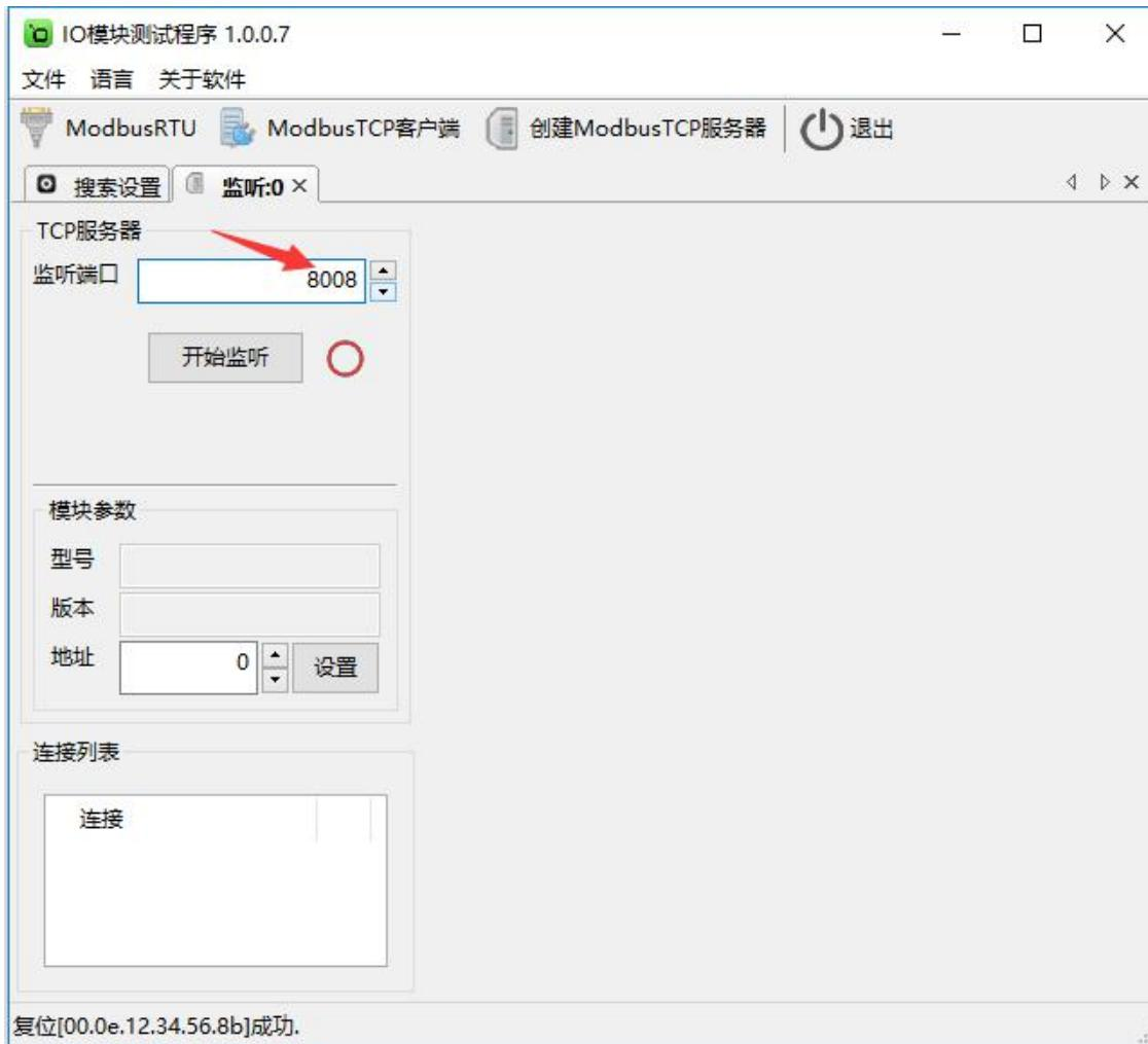
监听端口输入“8008”（注意：此端口号一定和服务器端口号一致，否则不能通讯），点击“开始监听”图标，模块网络连接建立之后，“开始监听”按钮会变为“结束监听”按钮，同时测试界面左半部分显示为设备的 TCP 服务器参数（监听端口“8008”），模块参数（型号，版本，地址），连接列表会显示所有该局域网的 IO 网络模块。右半边测试软件会根据产品型号自动显示所对应的测试界面，显示为采集 AI 的数值，AI 状态为只读值，显示模拟值和数值量，可以很直观地看到它各路的状态（采集集 0~20mA 模拟量值时，模拟量标定系数默认为“1”，模拟量标定差值默认为“0”；采集 4~20mA 模拟量值时，点击“模拟量标定系数”按钮，标定为“1.25”，点击“模拟量标定差值”按钮，标定为“-5”）。如下图：
