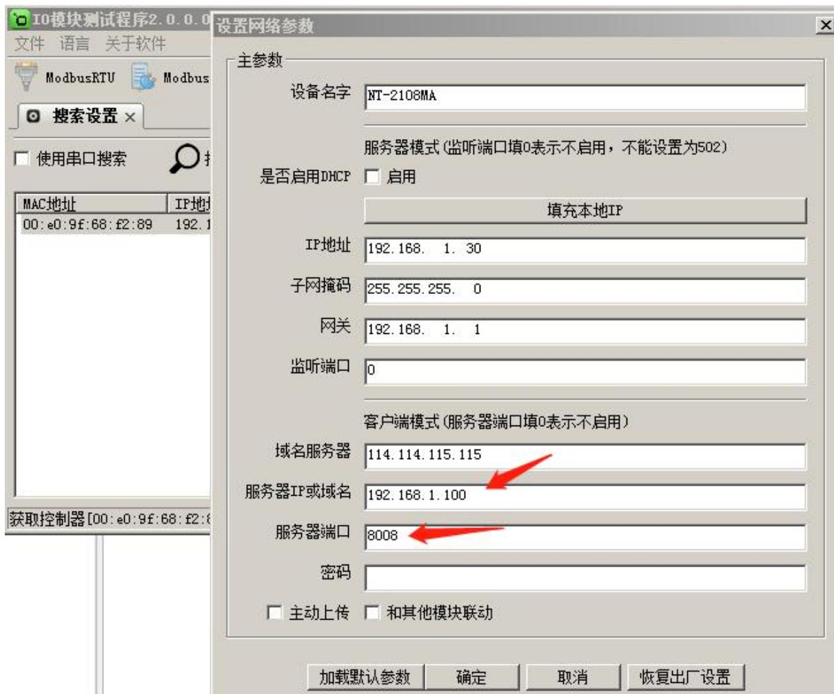
选中要设置的模块，点击“创建 Modbus TCP 服务器”图标或者鼠标右键选择“监听模块”，如下图：
