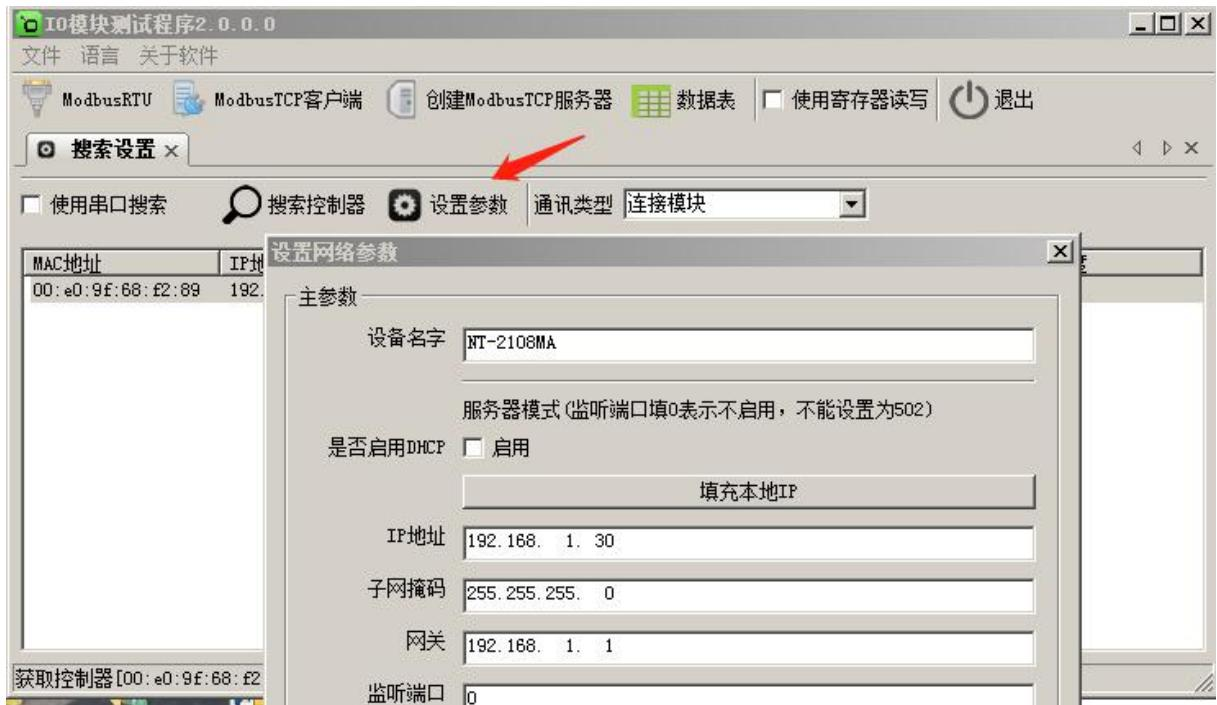
如果模块作为客户端连接到一个服务器，则“服务器IP或域名”和“服务器端口”也要设置，再点击“确定”图标，模块会保存新的参数并重启。如下图：
