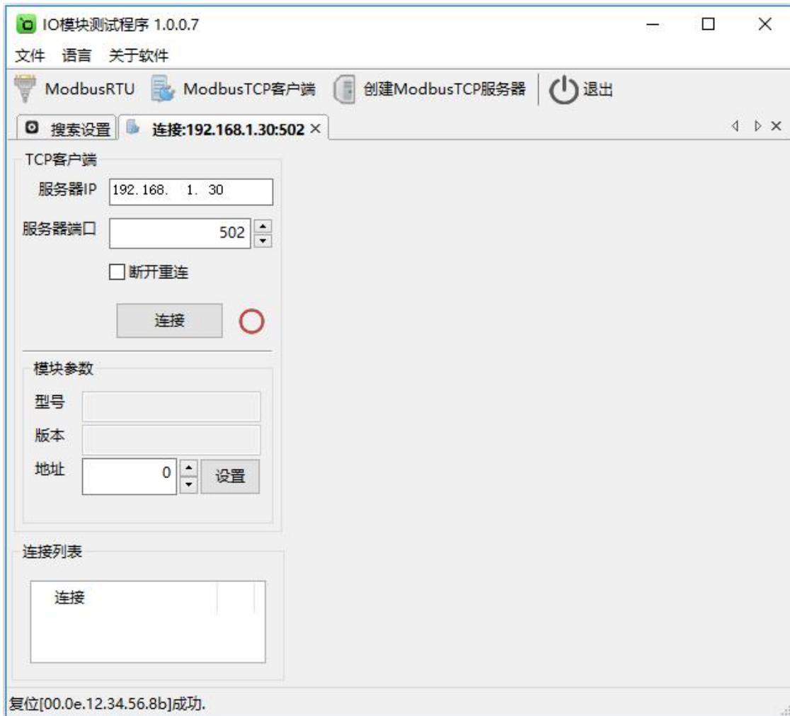
点击“连接”图标，模块网络连接建立之后，“连接”按钮会变为“断开”按钮，同时测试界面左半部分显示为设备的 TCP 客户端参数（IP 地址（默认 192.168.1.30），服务器端口（默认 502）），模块参数（型号，版本，地址），连接列表会显示所有该局域网的 IO 网络模块。右半边测试软件会根据产品型号自动显示所对应的测试界面，显示为采集 AI 的数值，AI 状态为只读值，显示模拟值和数值量，可以很直观地看到它各路的状态（采集集 0~20mA 模拟量值时，模拟量标定系数默认为“1”，模拟量标定差值默认为“0”；采集 4~20mA 模拟量值时，点击“模拟量标定系数”按钮，标定为“1.25”，点击“模拟量标定差值”按钮，标定为“-5”）。如下图：
