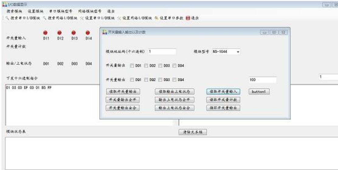
如需要修改模块站号地址，可以点击设置串口 I/O 模块，输入模块的默认地址（默认为 1），后面再输入写入的新地址，点击设置地址码，然后将模块断电重启，地址才会生效。如图所示：
